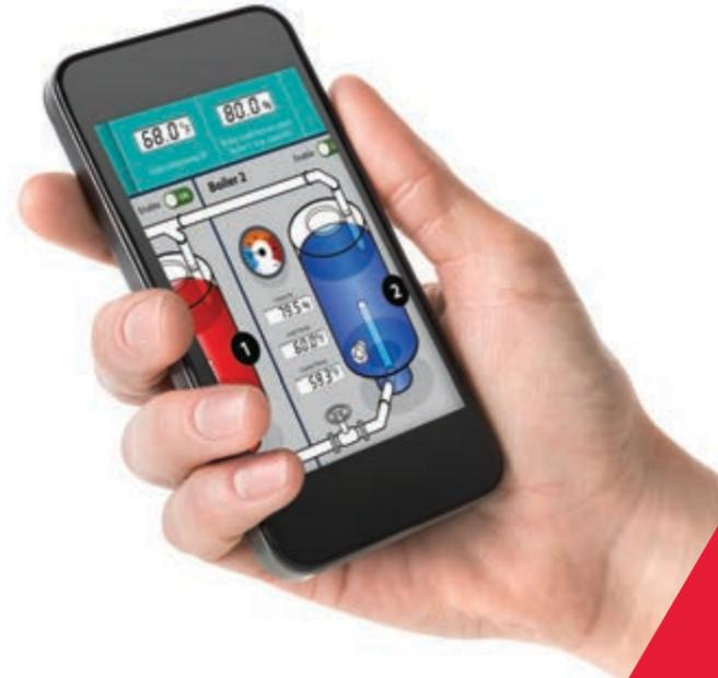
Connectez-vous directement via Ethernet ou USB, ou utilisez le mode VNC pour vous connecter à partir d'un smartphone, d'une tablette ou d'un PC. Utilisez votre navigateur pour surfer sur le serveur Web intégré d'UniStream.
