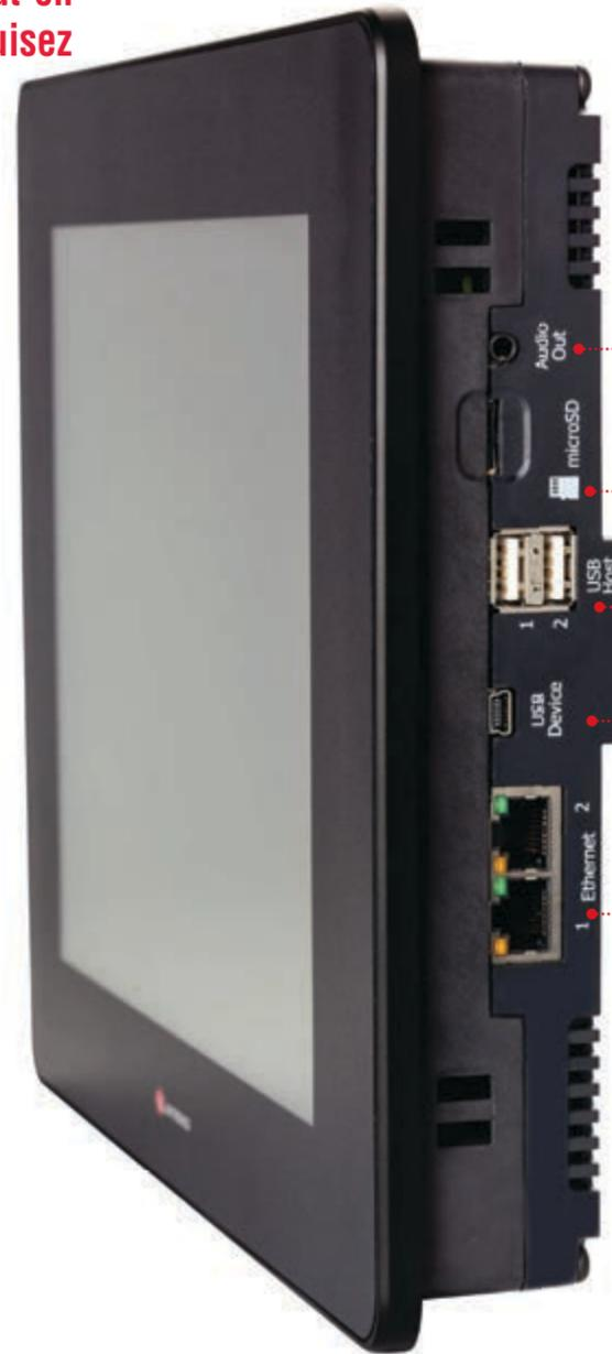
Intégrez d'autres périphériques via EtherNet/IP™, CANbus ou RS232/485 en utilisant MODBUS ou CANopen. Utilisez l'outil de création de trames UniLogic® pour adapter UniStream à n'importe quel protocole.
